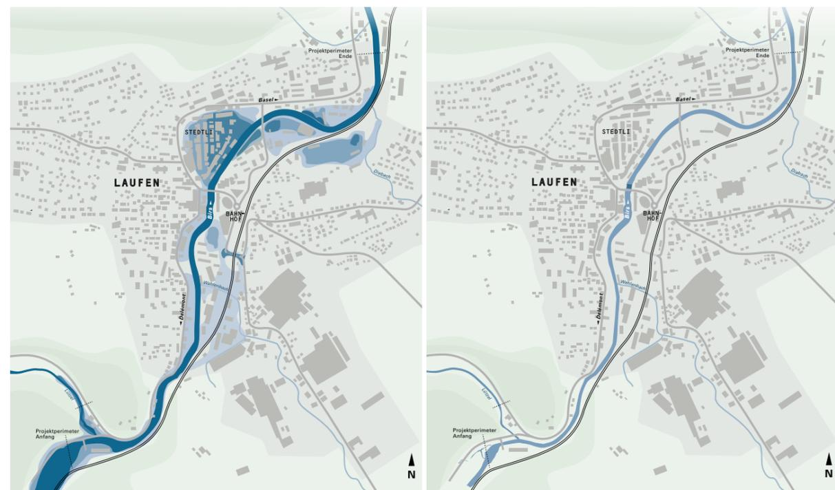
Überschwemmungsgefahr entlang der Birs bei einem 100-jährigen Hochwasser wie jenem von 2007: links die aktuelle Gefährdung, rechts die Situation nach Umsetzung des Hochwasserschutz-Projekts Laufen.
