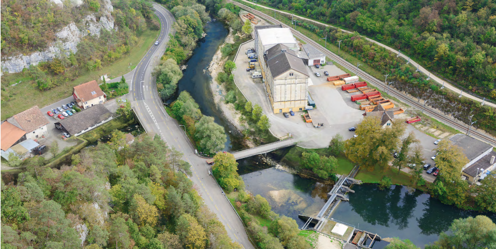
Den Birsabschnitt entlang der Birsmill prägt eine Eintiefung der Sohle von bis zu einem halben Meter, kombiniert mit einer Aufweitung um rund 8 Meter. Links im Bild der Abzweiger ins Lützel bzw. die Lützel mit ihrer Einmündung in die Birs. Am Seitengewässer werden Schutzmauern und ein Schutzwall gebaut.
